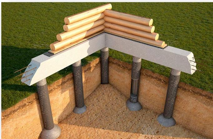
Выступающие над землей оголовки срезаются на заданной высоте и соединяются ростверком. Глубина таких свай может достигать 50 метров.
