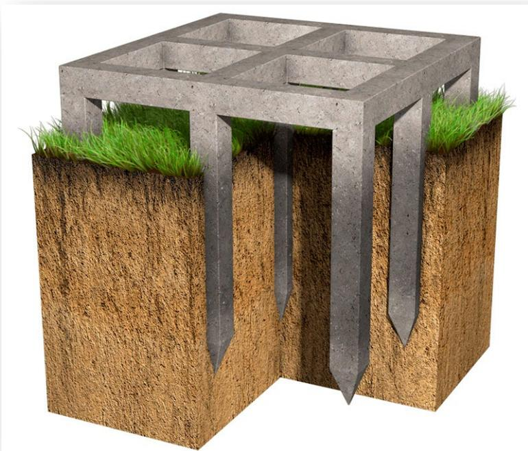
Рассмотрев все основные виды фундамента для частного дома выбор оптимального варианта упрощается. Для кирпичных, блочных и каменных зданий оптимальный фундамент ленточный. Для каркасного строительства, домов из бруса и бревна более подходят плитные или свайные (винтовые), на прочных грунтах — столбчатые. Но в каждом
